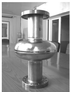
图2 北京大学研制的1.3GHz大晶粒单cell超导腔
