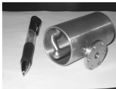
图 2 高阶模耦合器实物图
